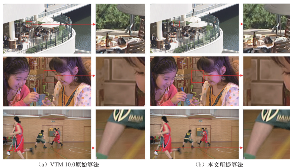
图9 本文算法与原始编码器的解码帧比较
